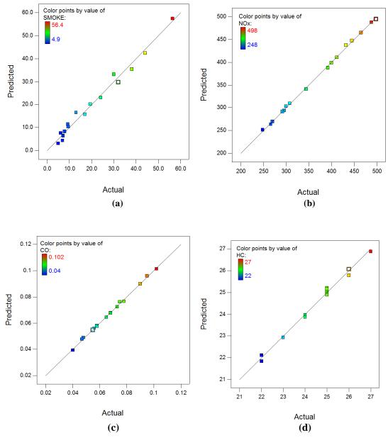
Fig. 4.80 Plot of actual values vs. predicted values for (a) Smoke (b) NO<sub>x</sub>(c) CO (d) HC
