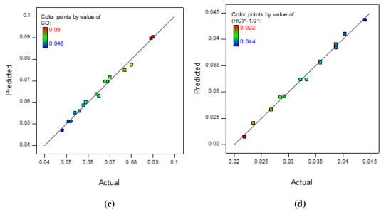
Fig. 4.12 Plot of actual values vs. predicted values for (a) Smoke (b) NO<sub>x</sub>(c) CO (d) HC
