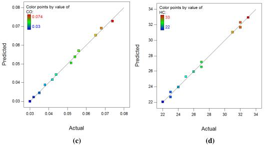
Fig. 4.59 Plot of actual values vs. predicted values for (a) Smoke (b) NO<sub>x</sub>(c) CO and (d) HC
