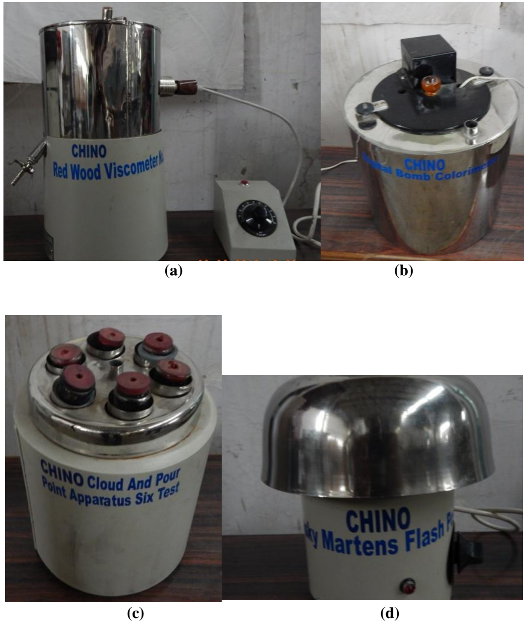
Fig. 3.2 Setup for measurement of fuel properties (a) Redwood Viscometer (b) Bomb calorimeter (c) Cloud and Pour point apparatus (d) Flash and Fire point apparatus
